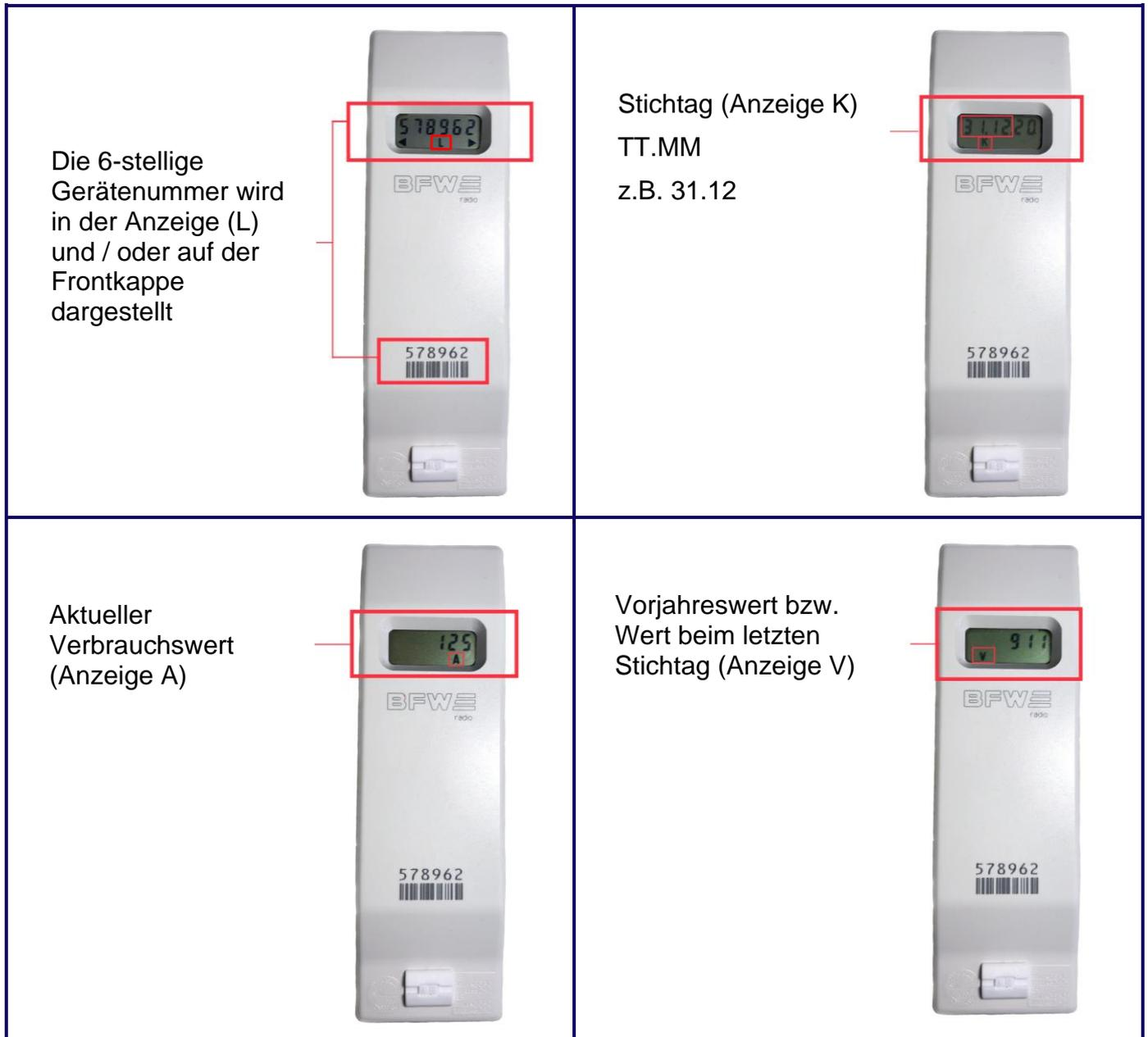
Die Werte werden in einer durchlaufenden Schleife automatisch angezeigt. Bitte lesen Sie den Stichtagswert (Anzeige V) und den aktuellen Verbrauchswert (Anzeige A) ab und notieren Sie diese im Ableseprotokoll entsprechend bei der jeweiligen Gerätenummer (Anzeige K).
