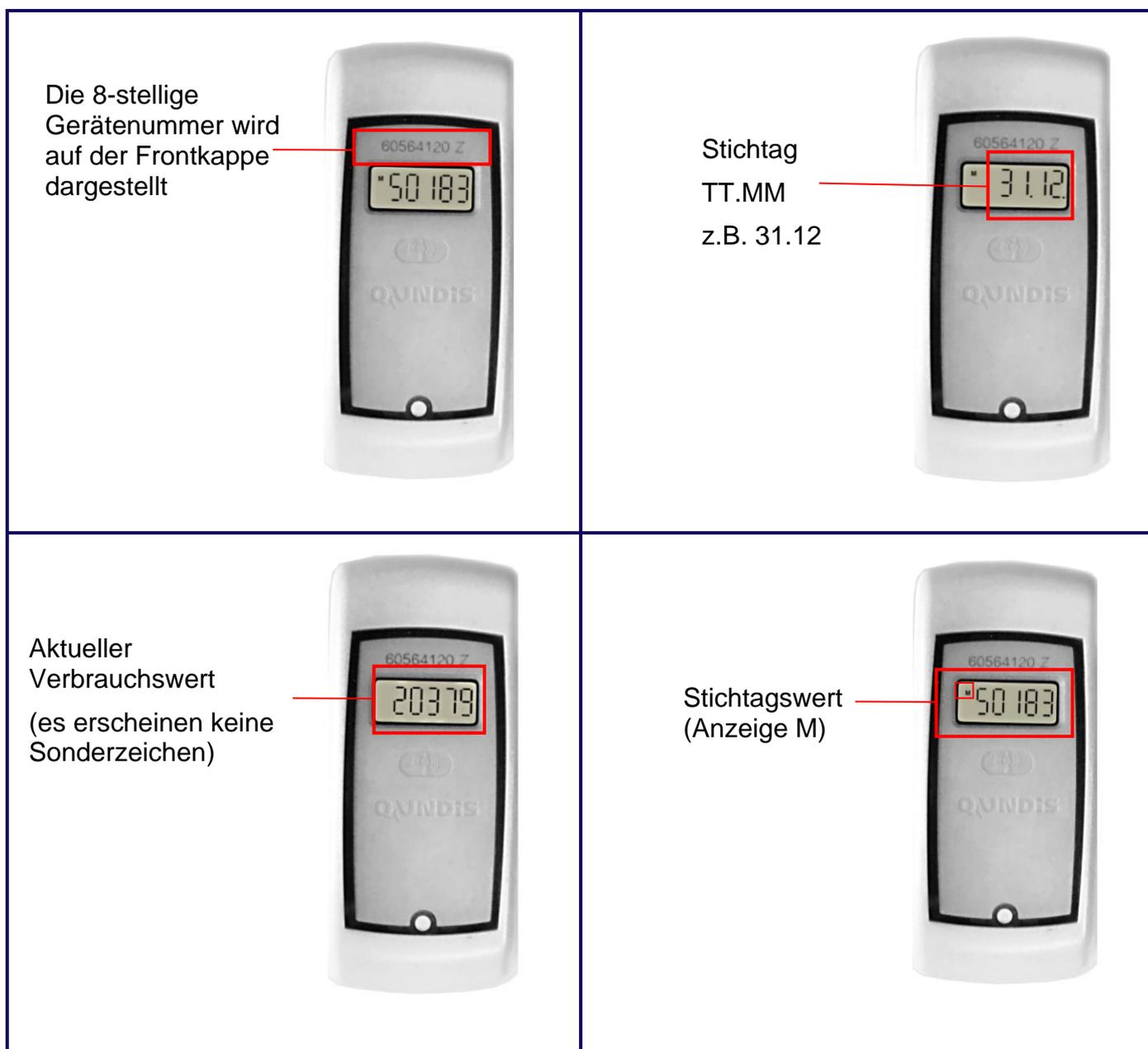
Die Werte werden in einer durchlaufenden Schleife automatisch angezeigt. Bitte lesen Sie den Stichtagswert (Anzeige M) und den aktuellen Verbrauchswert (ohne Sonderzeichen) ab und notieren Sie diese im Ableseprotokoll entsprechend bei der jeweiligen Gerätenummer.
